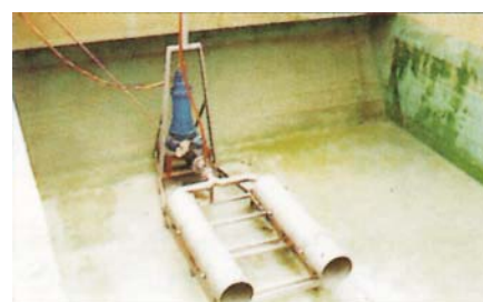
O sistema Ventoxal, com uma concepção compacta (bomba, venturi e hidrojetores), garante uma dissolução eficaz do oxigênio no efluente líquido.
