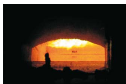
Utilização dos queimadores ALGLASS FC™, baixo NOx, na fusão do vidro
